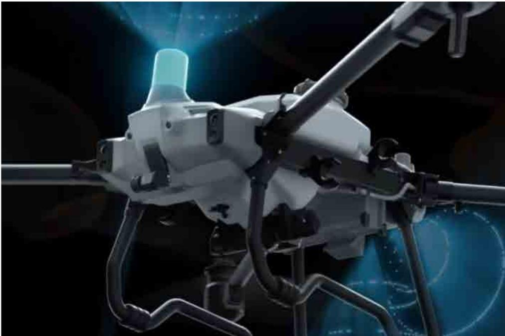
El radar activo phased array se incorpora con un sistema de sensores de visión binocular para proporcionar una detección de obstáculos omnidireccional de 360 grados, ofreciendo una seguridad óptima. La distancia de detección de hasta 50 m [7] permite un seguimiento inteligente del terreno, un escalado suave y la superación de múltiples obstáculos. La aeronave DJI Agras aborda terrenos complejos con facilidad, incluso en huertos accidentados.
